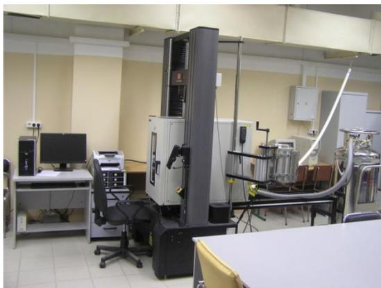
Рис. 1. Испытательная машина INSTRON 5982 с климатической камерой Instron-SFT 3119
